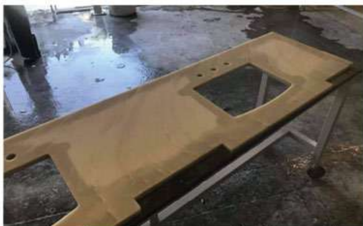
Humedecimiento de los bordes después del corte en taller
